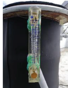
(d) Flow meter
